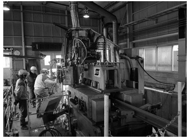
写真6 溶接機 (西日本旅客鉄道(株))
